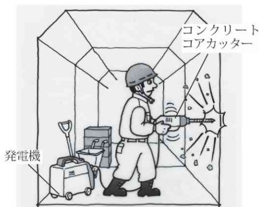
図 トンネル内での作業
